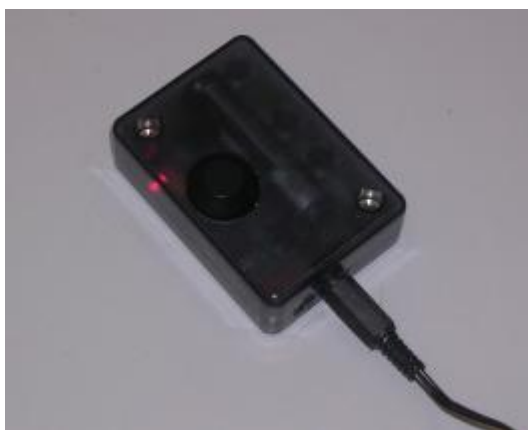
Рис. 16 Зарядка аккумулятора в модуле излучателя
