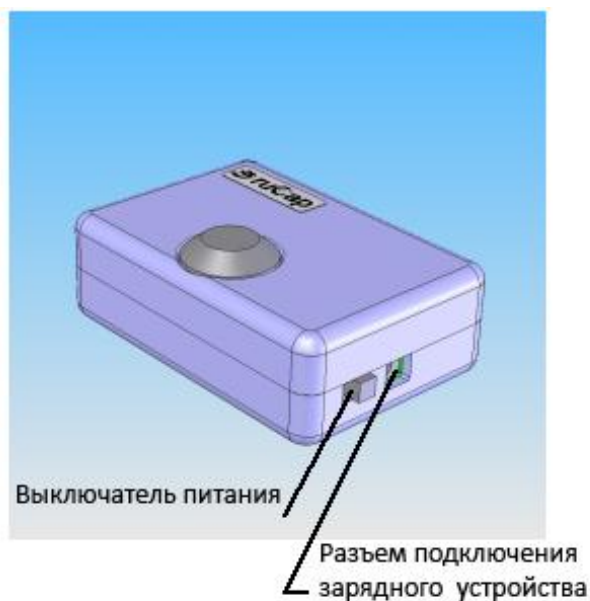
Рис. 2 Внешний вид модуля излучателя с одним передатчиком
