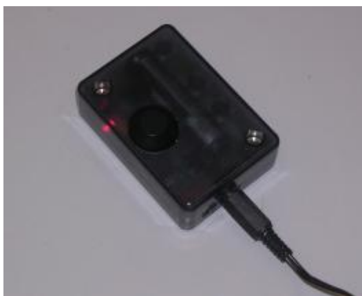
Рис. 16 Зарядка аккумулятора в модуле излучателя
